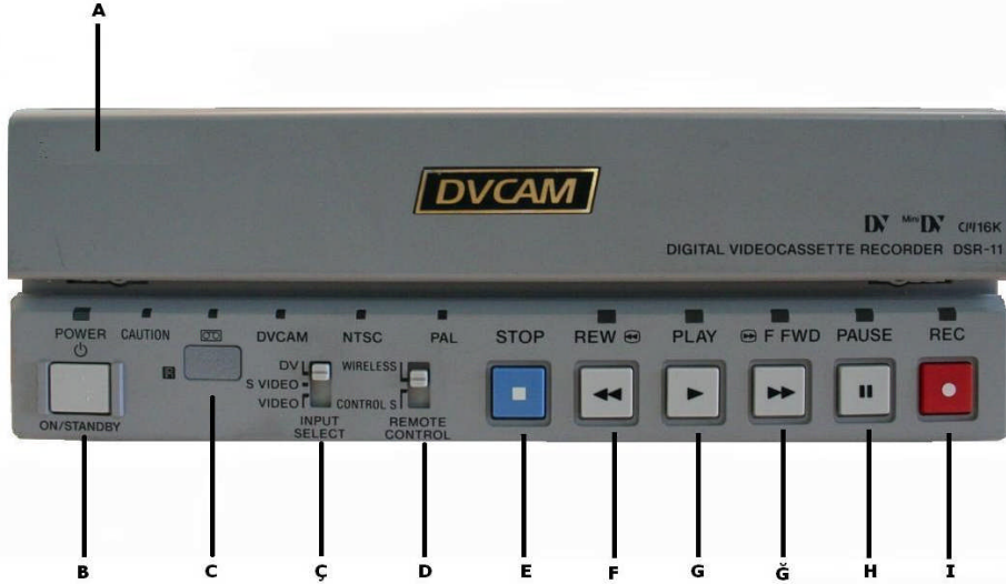
Şekil 3.1: Bir yarı profesyonel VTR cihazının ön yüzü. Tam profesyonel VTR cihazları daha büyüktür, gösterge ekranları ve daha fazla fonksiyon tuşları vardır.
